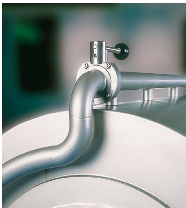
Декантерная центрифуга Foodес 500 с патрубком подключения системы безразборной мойки CIP
