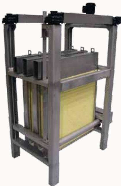
Фильтр ISO-DISC® разработан для непрерывного процесса, в котором используются элементы с зафиксированной фильтровальной тканью и все процессы динамичной, линейной обратной промывки контролируются посредством PLC или релейной панели управления. Все погруженные в воду узлы выполнены из коррозионно-стойкой нержавеющей стали или неметаллических материалов.
