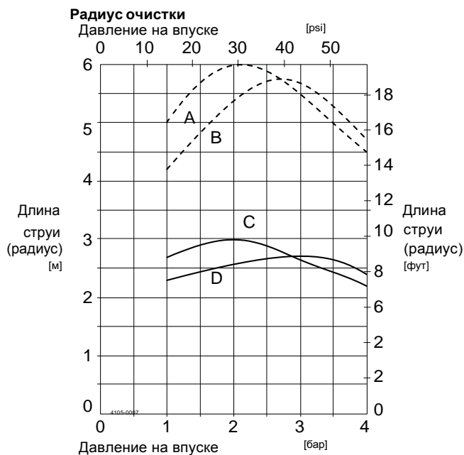
A = смачивание, сильный поток – B = смачивание – C = очищающее воздействие, сильный поток – D = очищающее воздействие
