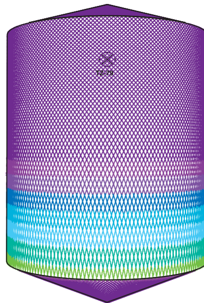
D 8 м Н 10 м, Toftejorg MJ50, 4 x ø10 мм, 0 % Время = 23,3 мин., расход воды = 10 868 л
