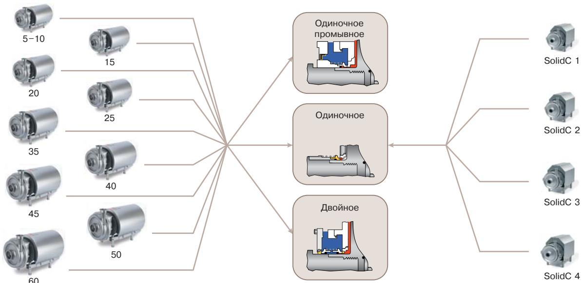
Однаковое уплотнение вала для удобства технического обслуживания и обеспечения эксплуатационной гибкости. Для всех стандартных моделей насосов LKH (LKH 5–60) и SolidC (SolidC 1–4) подходит один размер уплотнения вала, что позволяет всегда иметь на складе нужный тип уплотнения без дополнительных затрат. Кроме того, одиночное механическое уплотнение очень легко заменяется на промывное или двойное механическое при использовании всего нескольких дополнительных элементов.
