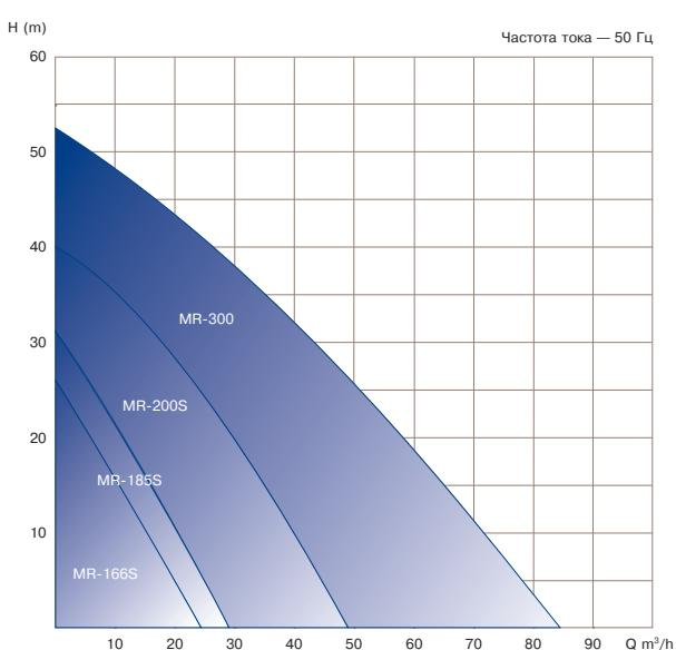
Жидкостно-кольцевые насосы MR надежны и экономичны при использовании для стандартных применений при производительности до 84 м<sup>3</sup>/ч.
