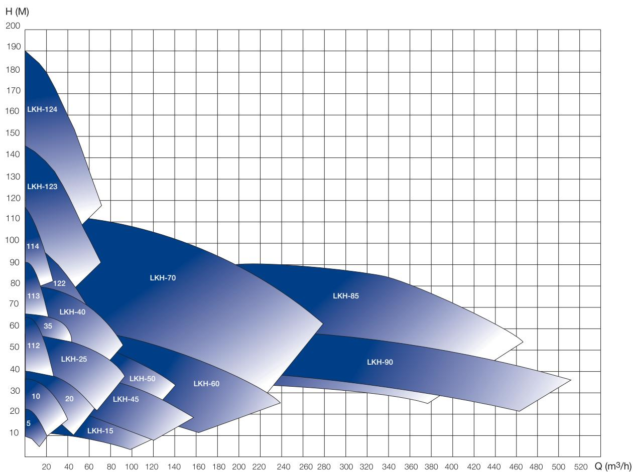
Характеристики насосов Насосы LKH выпускаются в вариантах исполнения производительностью до 500 м<sup>3</sup>/ч при напоре до 190 м (19 бар).
