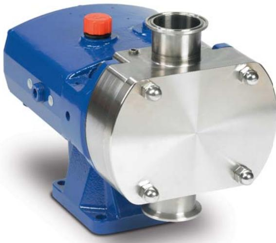
Насосы Альфа Лаваль серии SX — это кулачковые насосы класса «премиум», предназначенные для использования в процессах, требующих абсолютной стерильности оборудования и целостности конечного продукта. Благодаря оптимизированной конфигурации головки и применению многокулачковых роторов насосы SX работают с минимальными пульсациями и низким сдвигающим усилием. Это делает их наилучшим выбором для обеспечения целостности при перекачивании продуктов, требующих осторожного обращения.
