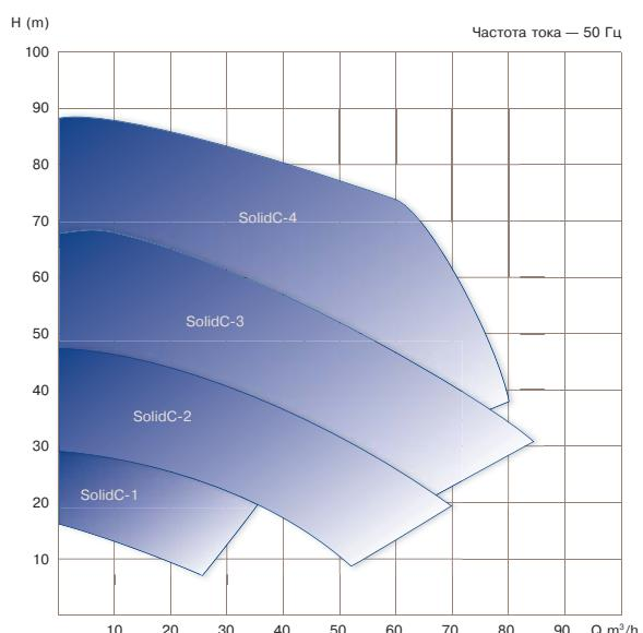
Характеристики насосов SolidC: надежный, экономически эффективный центробежный насос производительностью до  $85 \text{ м}^3/\text{ч}$ , предназначенный для стандартных применений.
