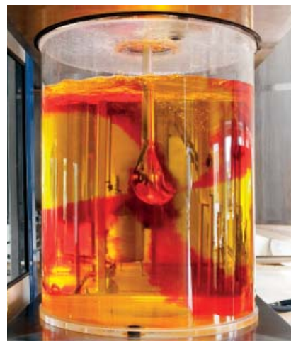
Роторные реактивные миксеры Iso-Mix впрыскивают жидкость, газ или порошок через вращающиеся форсунки — это не вызывает вращения всего объема.
